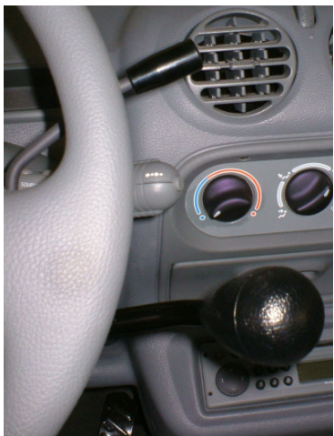
Accélérateur électronique au volant couplé à un frein principal à main
